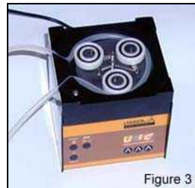
Fig. 3: Schlauch im Pumpenkopf
