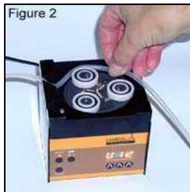
Fig. 2: Einführen des Schlauches
