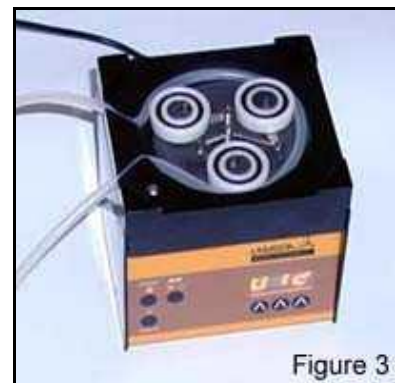
Fig. 3: Manguera / tubería en el cabezal
