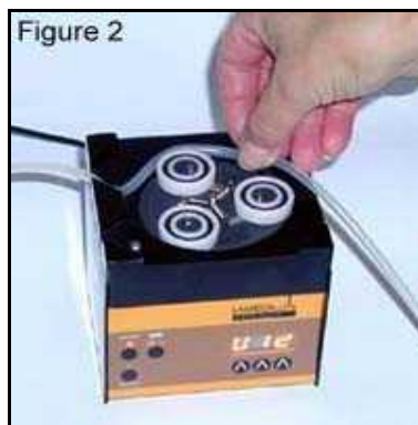
Fig. 2: Inserción de la manguera / tubería
